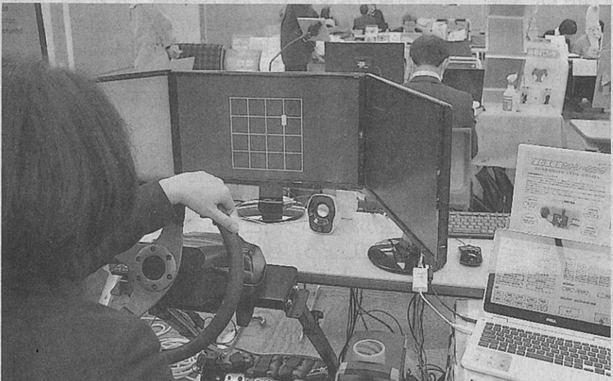
ラッキーソフトが開発したトレーニングシステムを使った模擬訓練の様子。移動する点に向かって、速く正確にハンドルを操作する。右下のパソコンで訓練項目と難易度を選ぶ＝2月13日、東京都内
